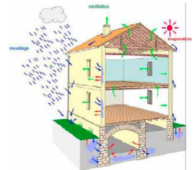
④ Ventilation naturelle par défauts d'étanchéité © IDE-Environnement
