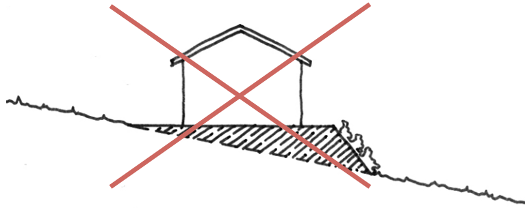
la mise à niveau par talutage
