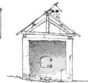
Mur en pierre charpente bois et couverture en tondres de milieu
